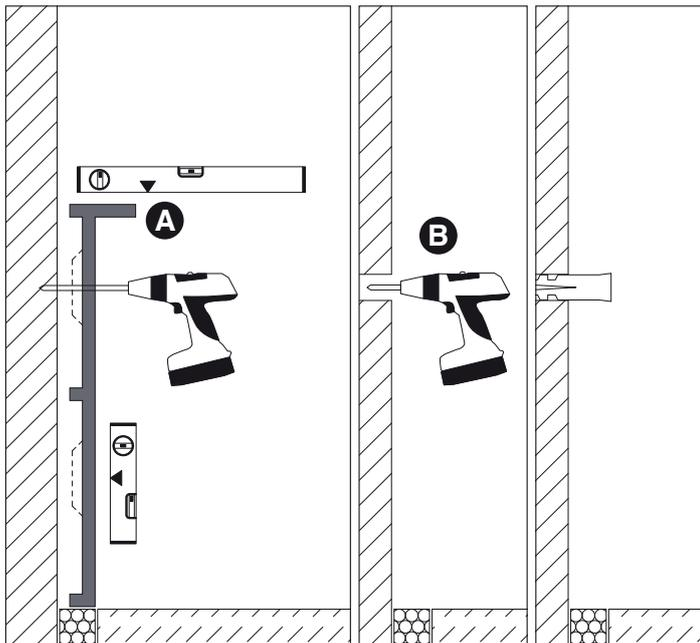
Nach dem Bemessen der Wandlänge und dem Profilschnitt mit der Bandsäge (A) das Profil an der Wand unter Berücksichtigung der OKFF ausrichten, anhalten und Löcher anreißen.
