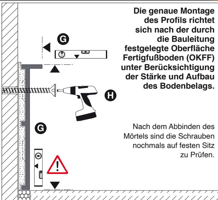
Die genaue Montage des Profils richtet sich nach der durch die Bauleitung festgelegte Oberfläche Fertigfußboden (OKFF) unter Berücksichtigung der Stärke und Aufbau des Bodenbelags.
