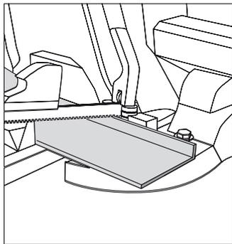
Alle Profilschnitte sind stets von der Sichtseite mit einer dafür geeigneten Metallbandsäge herzustellen. Nach dem Zuschnitt sind alle Kanten sauber zu entgraten.
