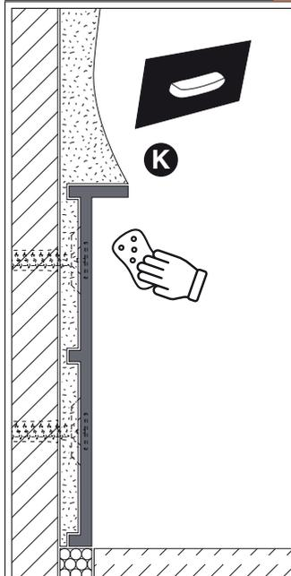
Nach der Montage dient das eingebaute Profil (K) als Putzlehre.
