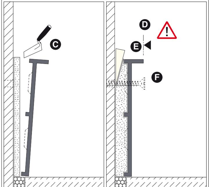
(C) Profile müssen im Zuge der Montage mit pastösem Mörtel (Gips-Ansetzbinder o.Ä.) hinterfüllt und mit einem Richtscheit abgezogen werden. Im Zuge der Montage ist die (D) vorgesehene Mindestputzstärke zu berücksichtigen. Nötigenfalls mittels (E) Fliesenlegerkeile oder Gummiringe im unmittelbaren Schraubenbereich hinterlegen. (F) Anschließend Schrauben durchsetzen.
