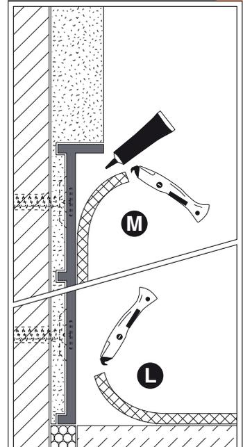
Nach Ende der Trockenbau bzw. Putzarbeiten können die (L) Bodenbeläge montiert und (M) in das Profil eingeklebt werden.
