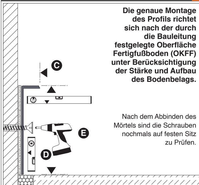
Die genaue Montage des Profils richtet sich nach der durch die Bauleitung festgelegte Oberfläche Fertigfußboden (OKFF) unter Berücksichtigung der Stärke und Aufbau des Bodenbelags.
