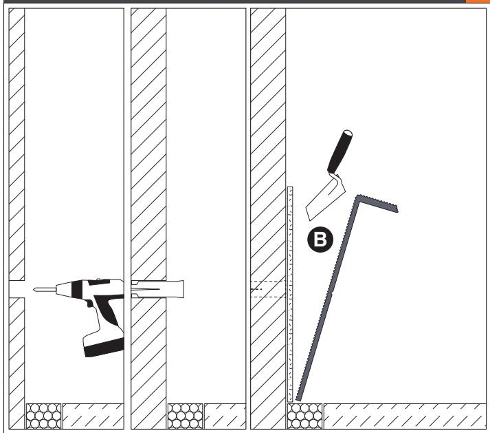
(B) Profile müssen im Zuge der Montage mit pastösem Mörtel (Gips-Ansetzbinder o.Ä.) hinterfüllt und mit einem Richtscheit abgezogen werden. Im Zuge der Montage ist die (C) vorgesehene Mindestputzstärke zu berücksichtigen. Nötigenfalls mittels Fliesenlegerkeile oder Gummiringe im unmittelbaren Schraubenbereich hinterlegen. Anschließend Schrauben durchsetzen.
