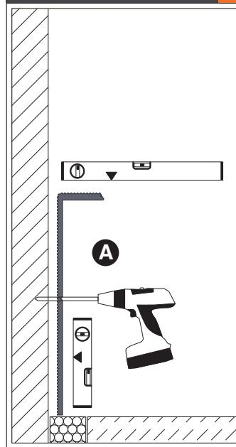
(A) Nach dem Profilzuschneid das Profil an der Wand unter berücksichtigung der OKFF ausrichten, anhalten und Löcher anreißen. Vorbohren und Dübel setzen.
