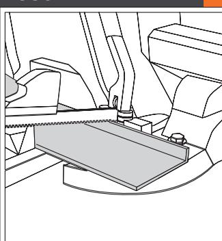
Alle Profilzuschneidte sind stets von der Sichtseite mit einer dafür geeigneten Metallbandsäge herzustellen. Nach dem Zuschnitt sind alle Kanten sauber zu entgraten.
