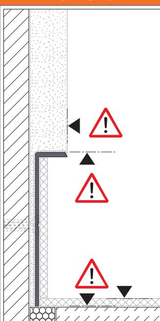
Die genaue Montagehöhe des Profils richtet sich nach der durch die Bauleitung festgelegte Oberfläche Fertigfußboden (OKFF)
