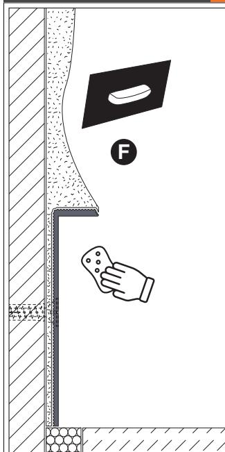
Nach der Montage dient das eingebaute Profil (F) als Putzlehre.
