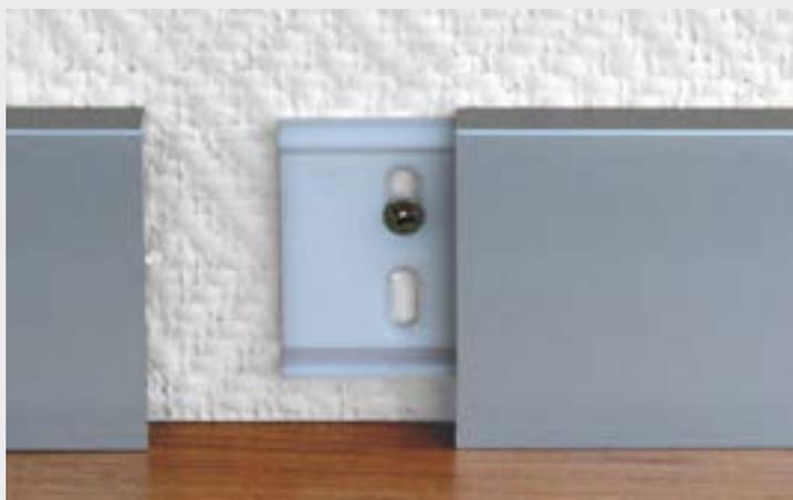
Bitte achten Sie bei Profilstößen und werkseitigen Formstücken darauf die Montageklipse stets mittig zur angesetzten Sockelleiste zu setzen.
