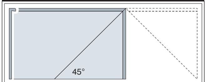
Für nebenstehendes Profil lassen sich durch einen passgenauen Gehrungsschnitt Endabschlüsse herstellen. Wahlweise können diese angeklebt oder angeschraubt werden. Bei der Montage ist auf einen ebenen Untergrund zu achten.
